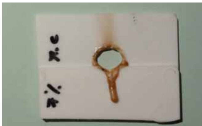
Esempio indicativo: 7 % melammina cianurata (formula standard). Passa (non si accende)
