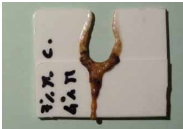
Esempio indicativo: 7 % melammina cianurata, 0,4 % nanoargilla. Passa (si accende e si spegne dopo 4 sec.)
