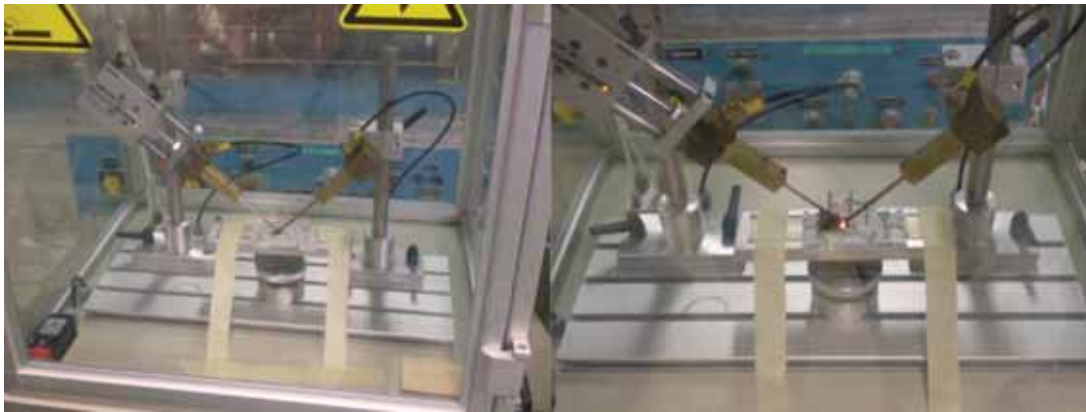
Prova di infiammabilità: prova di accensione all'arco (Arc ignition test)
